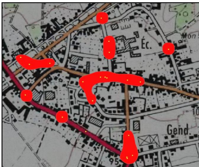
Résultat de l'érosion-dilatation (en rouge) à partir de la sélection des points établissements de type « centre ville » (en jaune). Fond scan 25 IGN.
