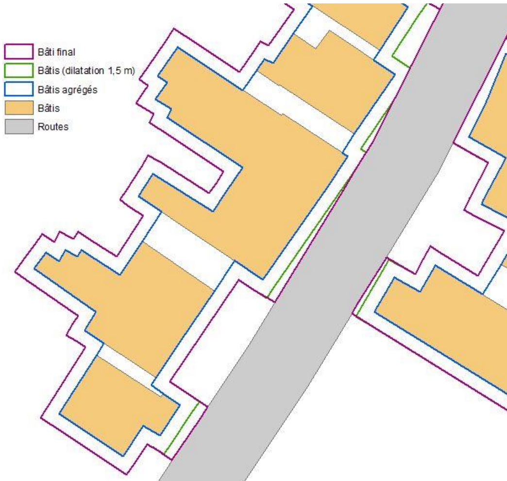
Figure 19 : Coïncidence avec l'ossature
